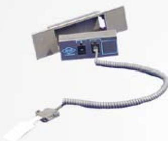
Batterie en cas de coupure secteur. Amplificateur du signal sonore lors de déconnexions successives des détecteurs avec présence lumineuse pour chacun d'eux.
