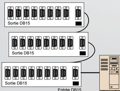
**Notre SPLITTER VGA vous permet de reproduire à partir d'une même source, la même image jusqu'à 8 écrans .**
